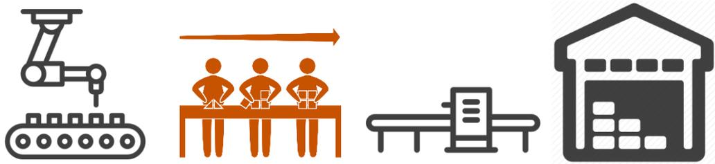
Los insumos se mueven de manera lineal de una estación a la siguiente en una secuencia ya fijada.
