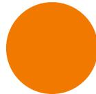
Las estaciones de trabajo o las tareas a realizar para transformar los insumos en productos se representan mediante círculos.
